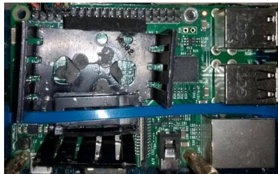
Ilustración 15 Tarjeta RASBERRY, etapa disipación de calor. Autores: Mario Guillén, Iván Tapia, 2017.
