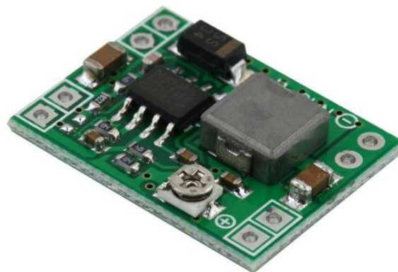
Ilustración 8Modulo Convertidor DC-DC Step Down Mini LM2596 3ª,(Mega, 2014)
