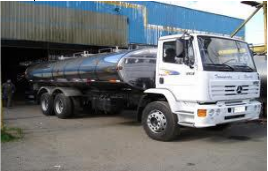
Camión Tanquero cap. 20000 litros con tanque de acero inox. Utilizada para transportar leche fría desde el acopio hacia las empresas.
