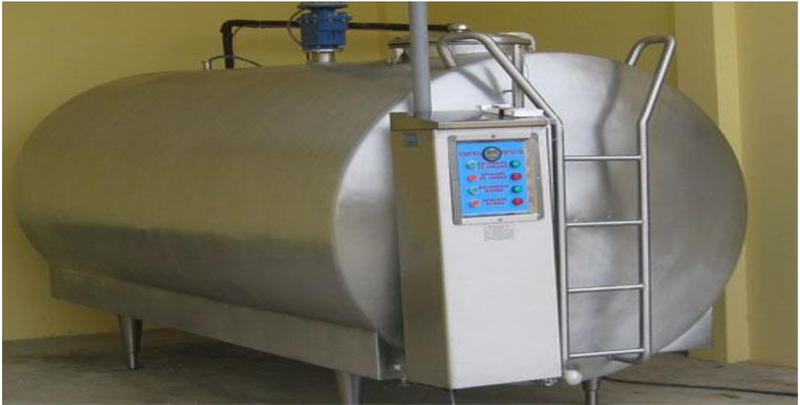
Tanque de enfriamiento de acero inoxidable equipado con agitador automático cap. 6200 litros
