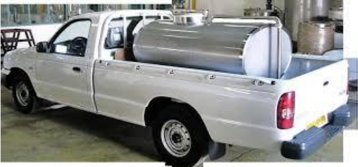
Camioneta Mazda 2200V provista de un tanque de acero inoxidable de capacidad de 1000 litros utilizada para la recolección de leche
