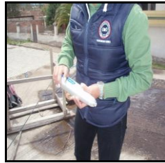
Gráfico 23. Equipo que sirve para realizar ensayo de hormigón endurecido.
