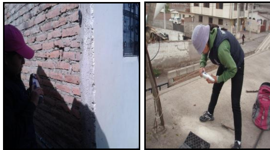
Gráfico 30. Lectura de esclerómetro.
