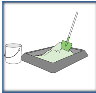
Gráfico 90. Preparación de concreto de forma manual.
