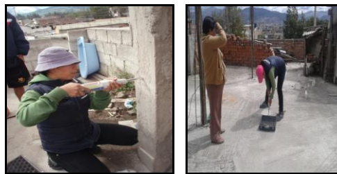
Gráfico 28. Proceso de ensayo esclerométricos
