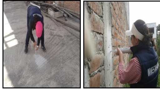
Gráfico 29. Proceso de ensayo con el esclerómetro
