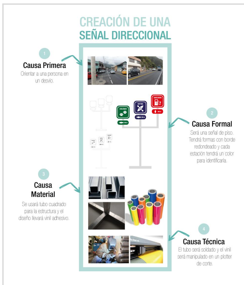
Figura 2.1: Ejemplo de la creación de una señal direccional, basada en el proceso de diseño de Robert Scott.
