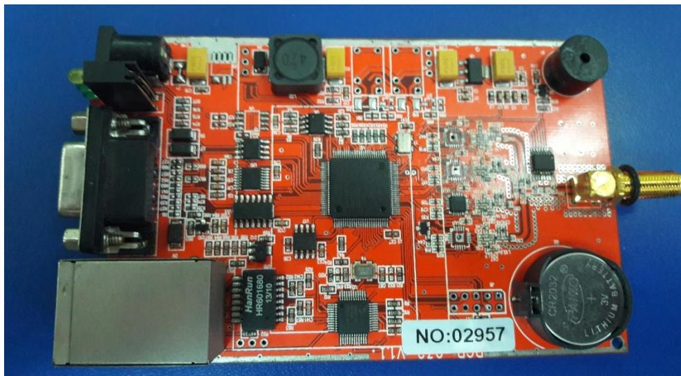
**Figura 42.** Placa del lector RFID
