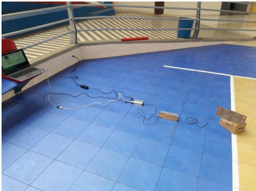
**Figura 28.** Pruebas del arreglo de antenas en el coliseo
