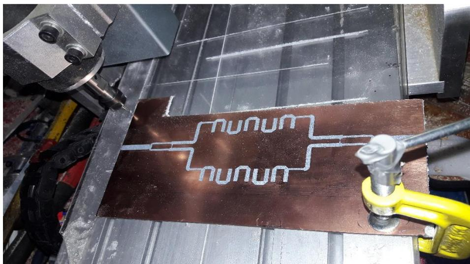
**Figura 39.** Corte en cnc de los filtros
