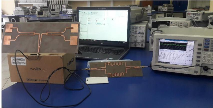
**Figura 26.** Pruebas de todo el sistema en el analizador de espectros.
