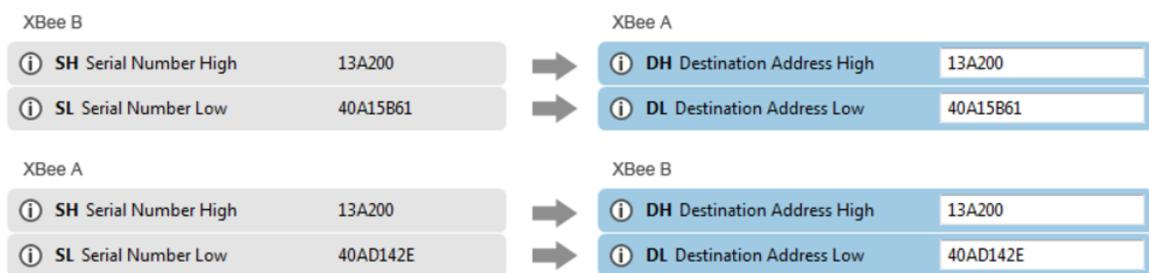
Figura 3. Direccionamiento DH y DL en dispositivos XBee
