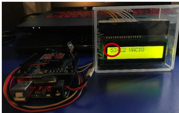
Figura 21. Muestra de valores convertidos de (V) a (cm)
