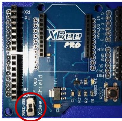
Figura 11. Switch selector del dispositivo XBee Shield
