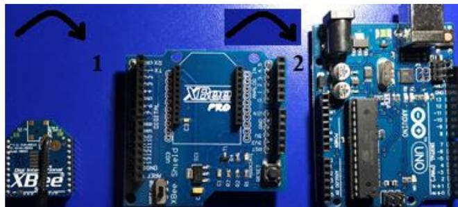
Figura 13. Orden de montaje módulos XBee/XB Shield/Arduino UNO
