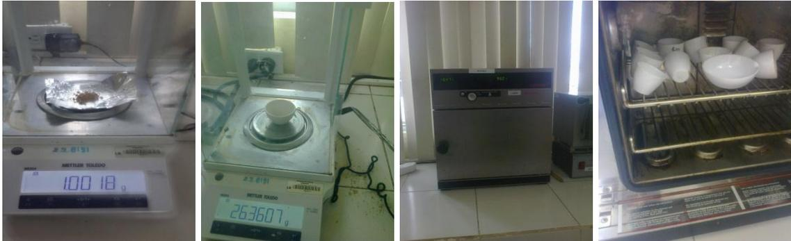
Pesado de muestras, secado de muestras en estufa y análisis de humedad y cenizas
