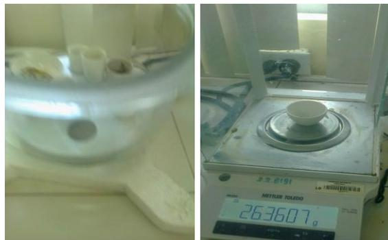
Reposa de muestra en disecador y pesado de muestra seca.
