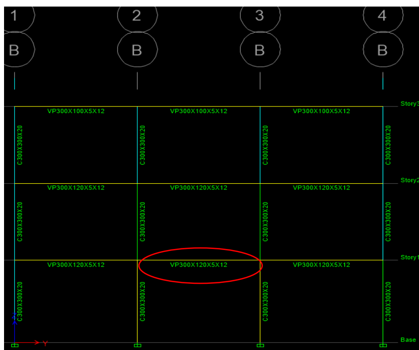
Figura 82. Vista en elevación del pórtico B.
