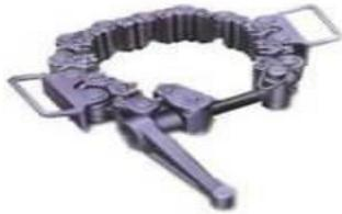
Nuestras cuñas de seguridad de perforación son herramientas de perforación petrolera usadas para tubos de junta lisa y collares de perforación. Tenemos dos modelos de cuñas de seguridad de perforación, que son WA-C Y WA-T. El modelo WA-C es adecuado para tubos de 3 1/2 a 15 5/8 pulgadas (88.9-396.9mm) OD y el modelo WA-T son para tubos de 1 1/8 a 4 1/2 (28.6-114.3 mm) OD.
