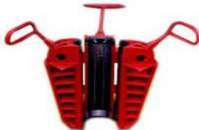
Nuestras cuñas de la varilla de perforación son aplicables a tubos de perforación de 23/8 a 51/2 pulgadas (60.3-139.7mm) OD. De acuerdo con la longitud de sujeción, son clasificadas en Tipo corto (SDS), Tipo medio (SDML) y Tipo extra largo (SDXL).
