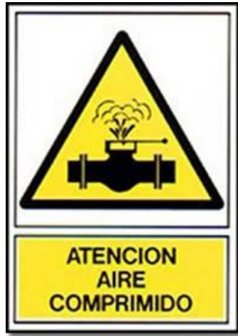
Ilustración 27. Señalética de advertencia de aire comprimido
