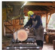
Recolectar los desechos de corteza que se acumulan sobre los motores eléctricos, para evitar que se genere un consumo extra de energía eléctrica.
