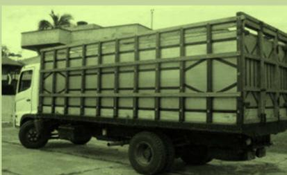
Para transportar la madera rolliza en camión con cajón, se toma en cuenta la capacidad promedio de carga que según el Ministerio del Ambiente es de 19 m<sup>3</sup>.
