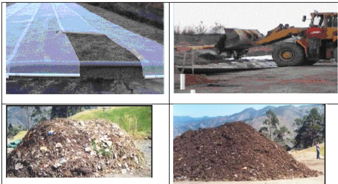
**Fig. 1.2.** Algunas etapas en el compostaje de residuos urbanos, (a) colocación de una geomembrana en el suelo, (b) volteo mecánico de pilas, (c) compost en fase mesofílica, (d) compost maduro. El compostaje es la degradación microbiana de sólidos orgánicos por medio de un proceso de oxidación que pasa por una fase termofílica. (Kolwzan, 2006)
