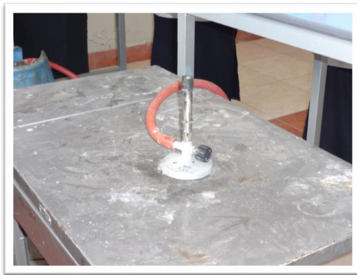
Mechero de Bunsen utilizado en la práctica de laboratorio
