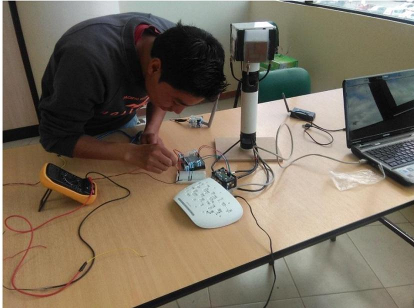
**Figura 92.** Comprobando Voltaje del sistema
