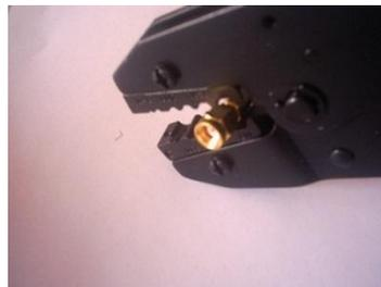
**Figura 64.** Ponchado cable RG58 y conector SMA
