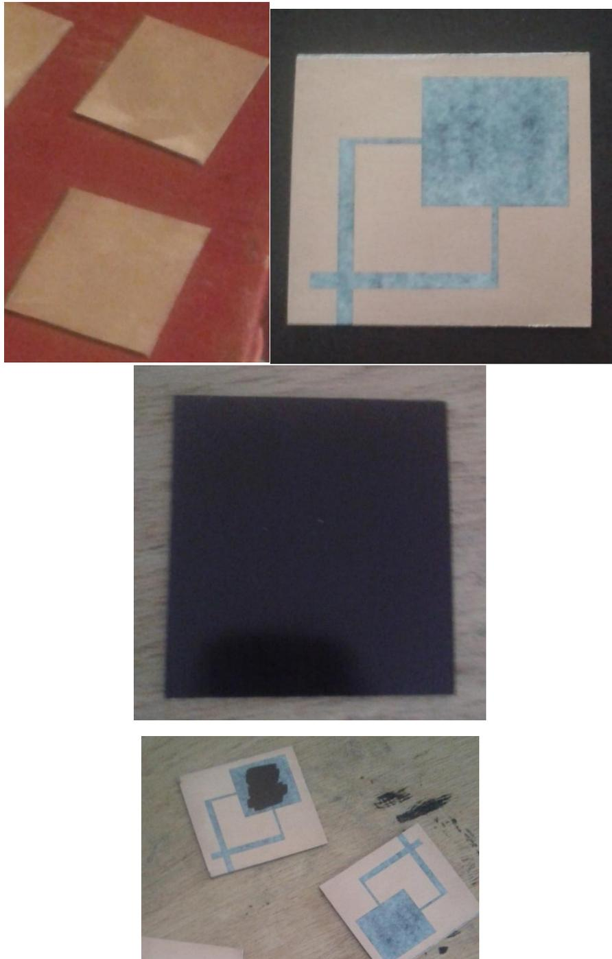
**Figura 95.** Diseños de antenas microstrip
