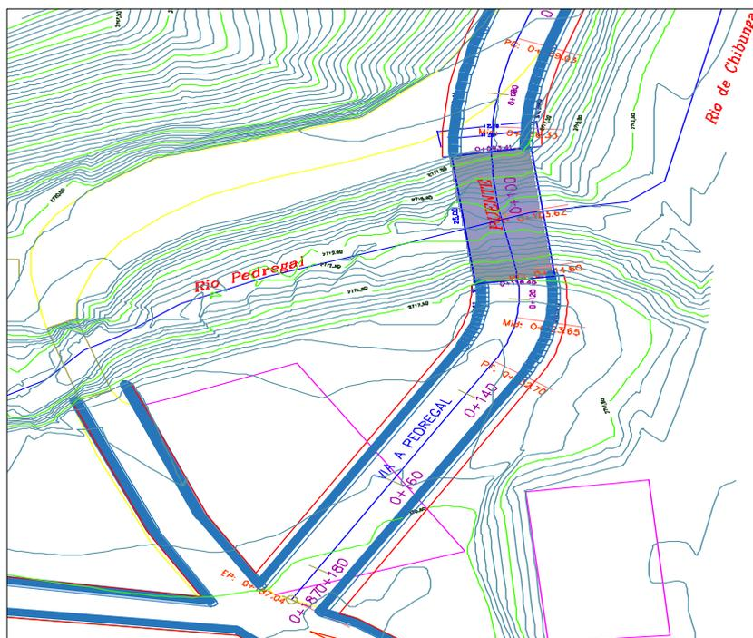
*Ilustración 42.- Alternativa dos (Geometría del puente).*
