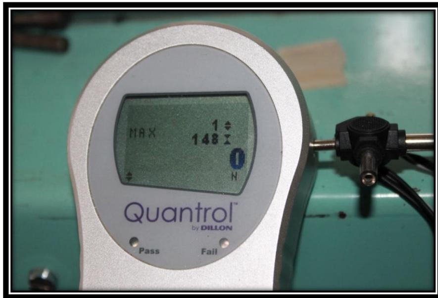
**Gráfico N° 28: Medidor de fuerza Electrónico Quantrol.**
