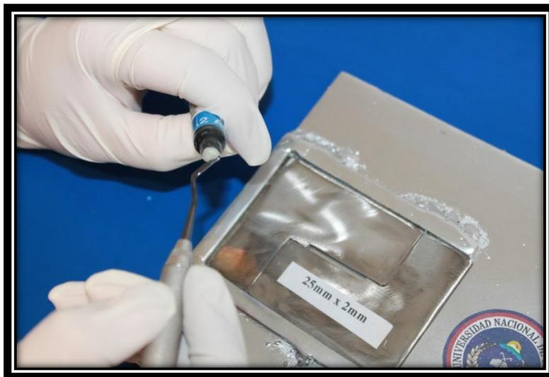
**Gráfico N° 15: Colocación de la resina sobre el molde.**
