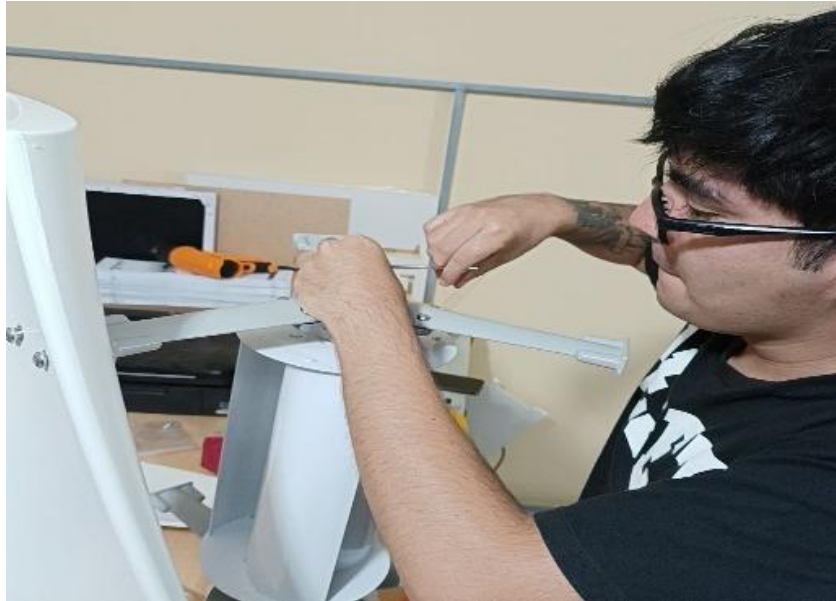
Figura 55. Ensamblaje del aerogenerador adquirido
