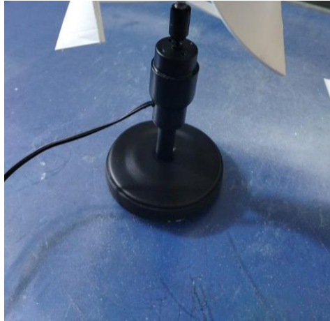
Figura 13. Base con sistema de acoplamiento intercambiable
