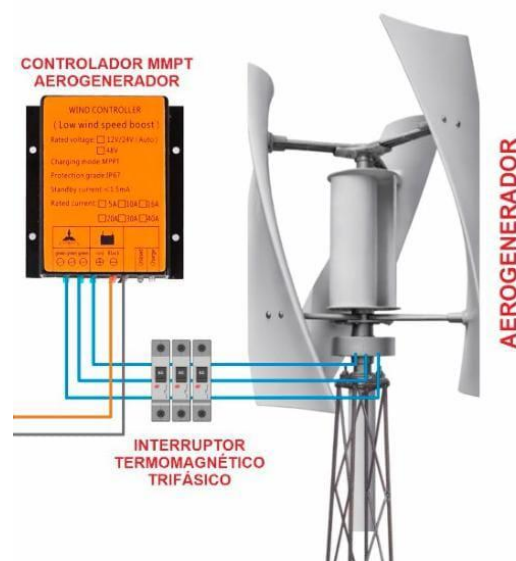
Figura 29. Conexión del aerogenerador al controlador eólico
