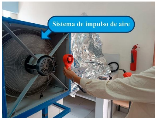
Figura 18. Ventilador en la parte posterior del túnel de viento
