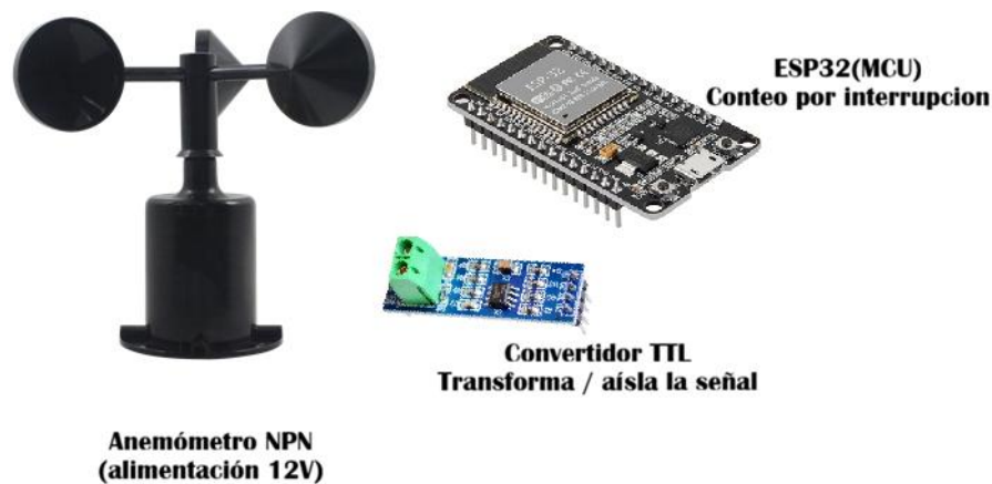
Figura 5. Componentes de medición del recurso eólico
