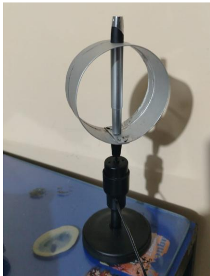
Figura 14. Ensamblaje del prototipo Darrieus
