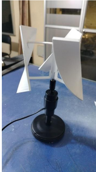
Figura 16. Ensamblaje del prototipo H-rotor
