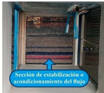
Figura 19. Malla dentro del túnel de viento
