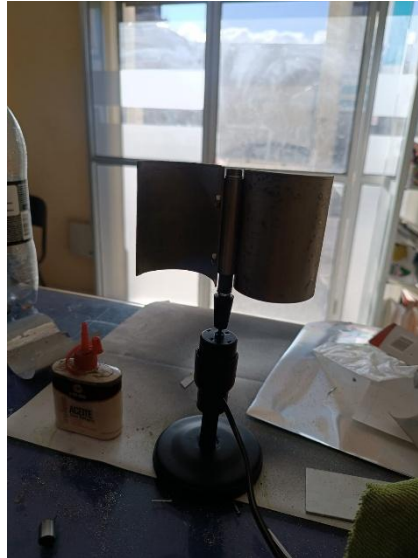
Figura 15. Ensamblaje del prototipo Savonius
