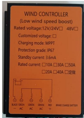
Figura 30. Controlador de carga MPPT del aerogenerador
