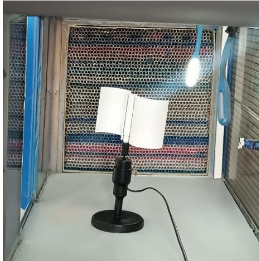
Figura 23. Prototipo Savonius en pruebas de túnel de viento
