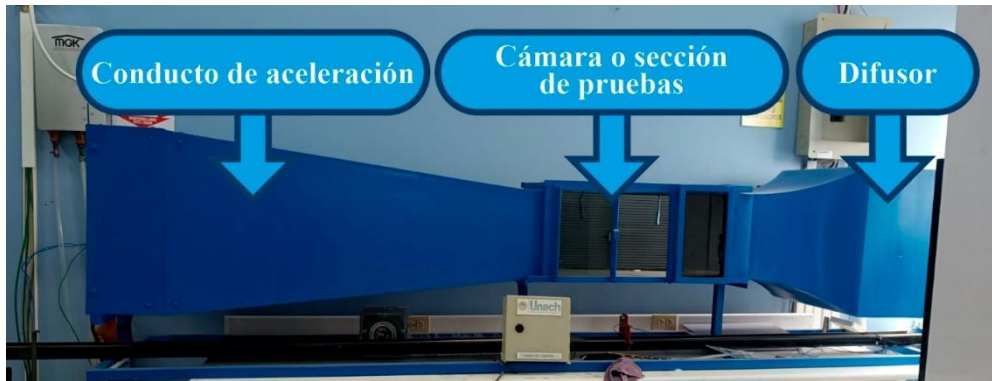
Figura 20. Arquitectura del túnel de viento (tobera, cámara de pruebas y difusor)
