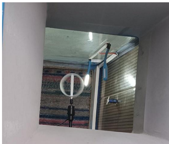
Figura 22. Prototipo Darrieus en pruebas de túnel de viento
