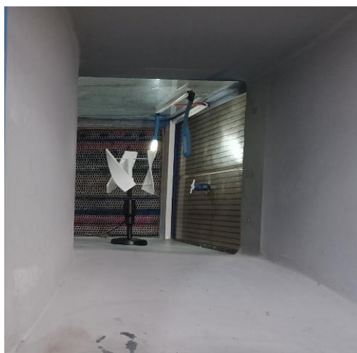
Figura 24. Prototipo H-rotor en pruebas de túnel de viento
