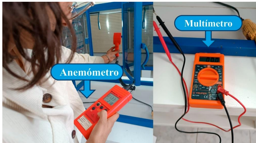
Figura 21. Instrumentos utilizados en la medición de pruebas de túnel de viento
