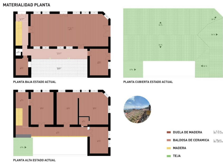
Figura 43. Materialidad en planta, estado actual
