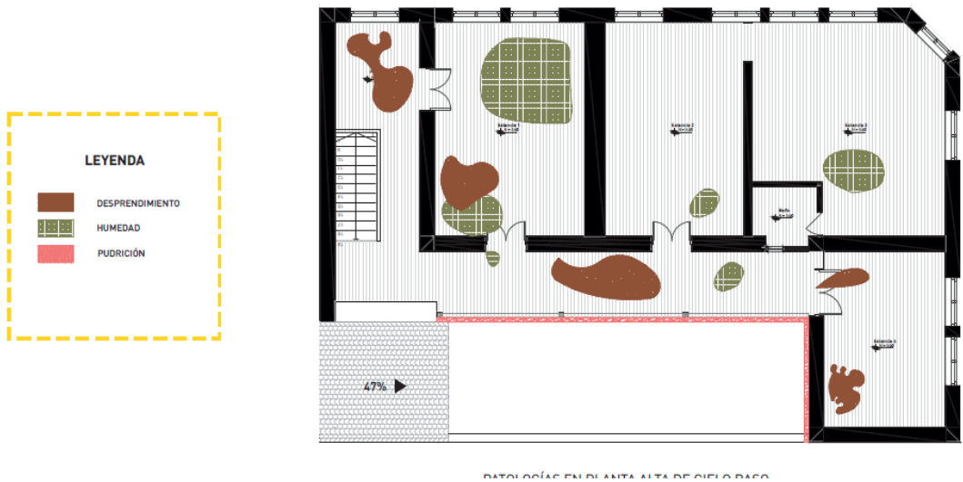
Figura 50. Levantamiento de patologías en planta alta de cielo raso
