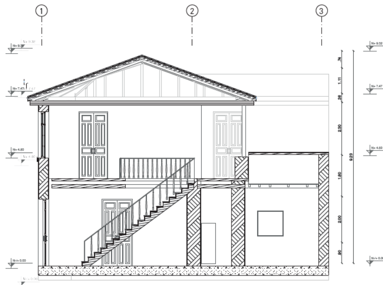
Figura 40. Sección transversal A.A, estado actual
