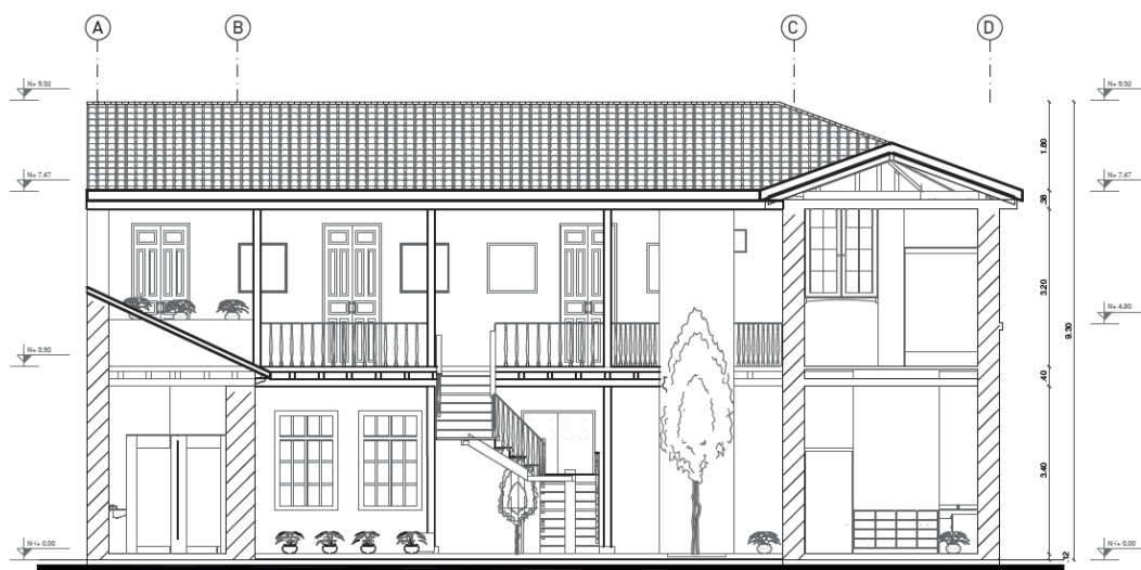
Figura 60. Fachada posterior adosada propuesta de intervención
