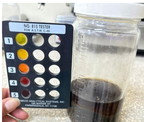
Figura 9. Ensayo colorimétrico ASTM C-40 de piroclasto triturado del volcán Sangay.
