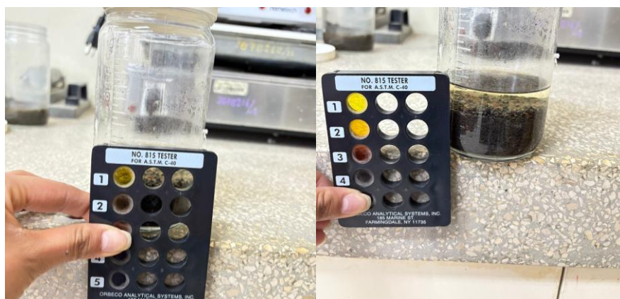
Figura 8. Ensayo colorimétrico ASTM C-40 de piroclasto triturado del volcán Tungurahua.
