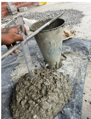
Figura 2. Ensayo de asentamiento (cono de Abrams) para mezclas de T-HE, S-HE y N-HE.
