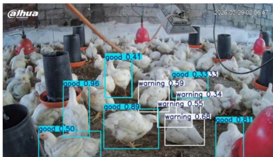
Ilustración 31: Imagen analizada con el modelo YOLOv26n
