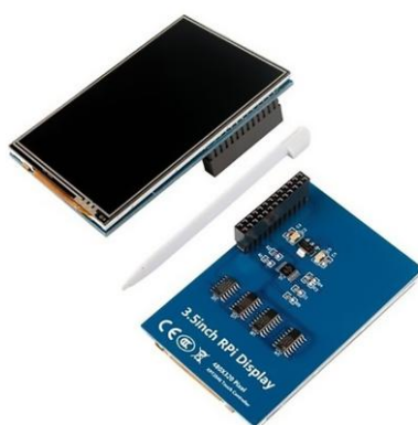
Ilustración 12: Pantalla LCD TFT Touch Raspberry Pi4 Pi 3.5 320×480 3.5
