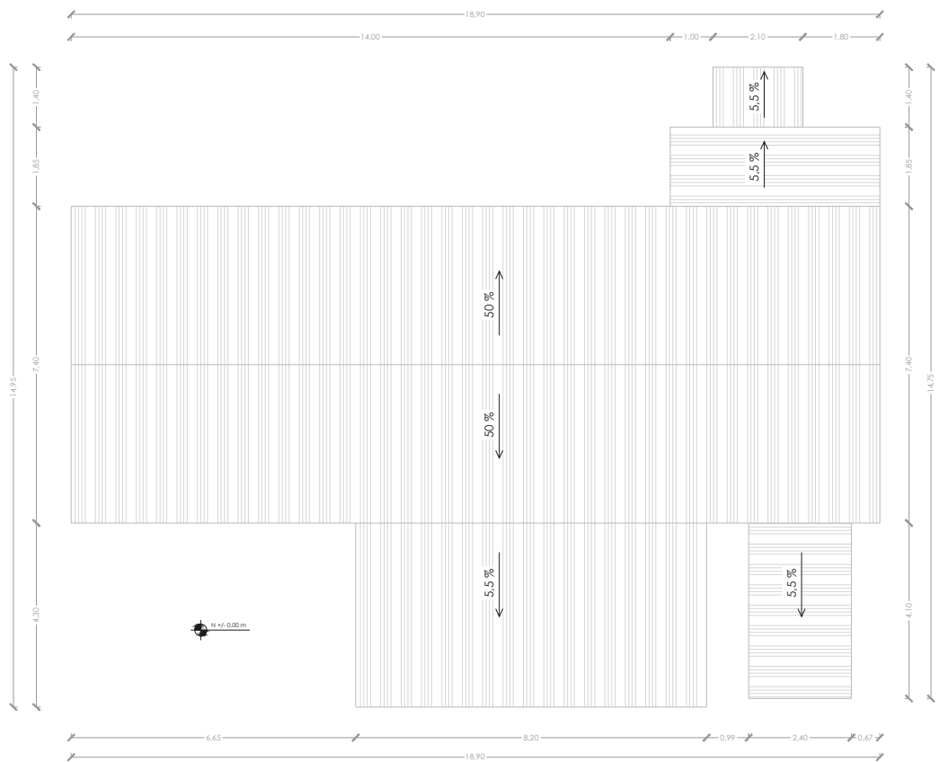
PLANTA DE CUBIERTAS ESC 1:100
