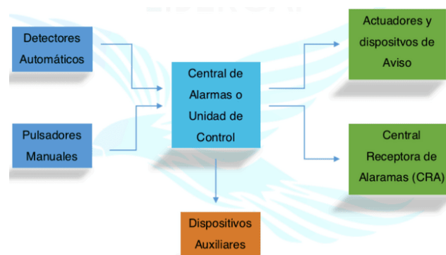
Figura 5. Bloques que componen un sistema de seguridad [18].
