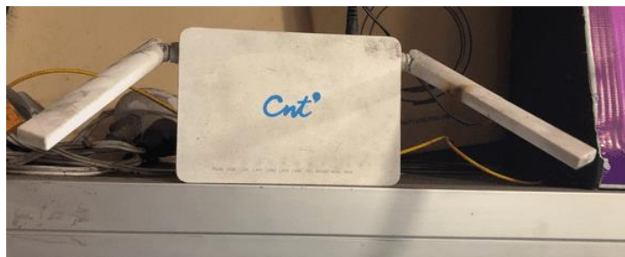
Figura 20. Router ONT, terminal de red óptica.
