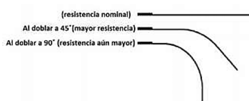
Figura 5. Funcionamiento general del sensor Flex.
