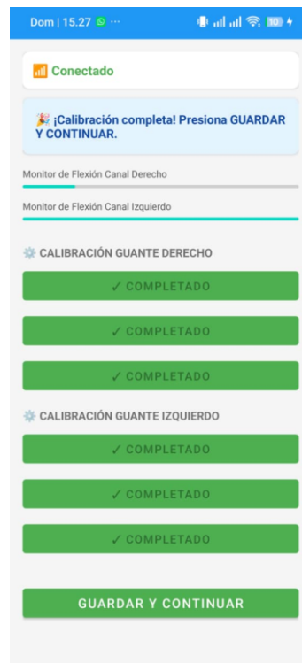
Figura 28. Calibración de los sensores Flex.
