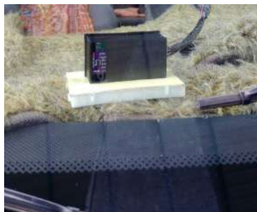
Figura. 3.20. Sensor VL53L0X zona delantera.
