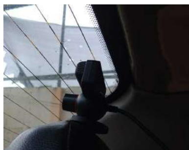
Figura. 3.22. Fly Cam (Z3) instalada en luneta trasera.
