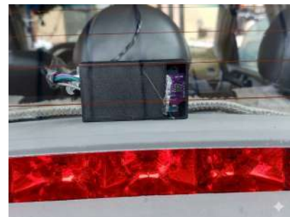
Figura. 3.21. Sensor VL53L0X zona trasera.
