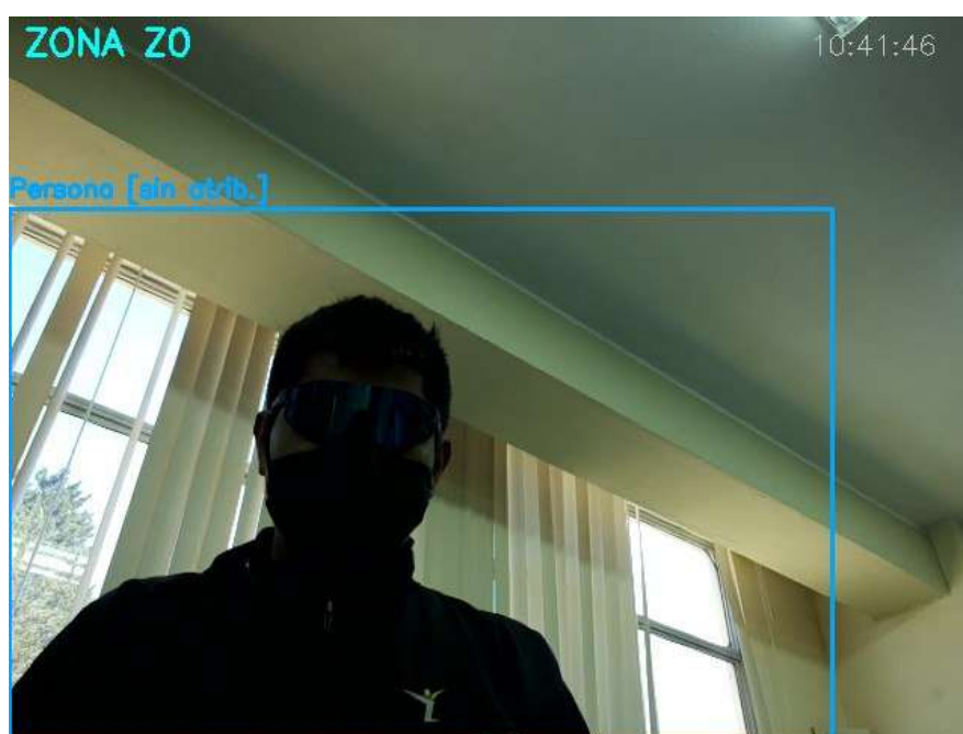
Figura. 1.48. Detección en condiciones de contraluz en la Zona Z0, a las 10:41:46. A pesar de la iluminación adversa, el sistema logró detectar la presencia de la persona y mostró la etiqueta Persona [sin atrib.] , lo que muestra que no se juntaron suficientes atributos para activar la alerta por ese mecanismo, quedando el temporizador de permanencia como respaldo.
