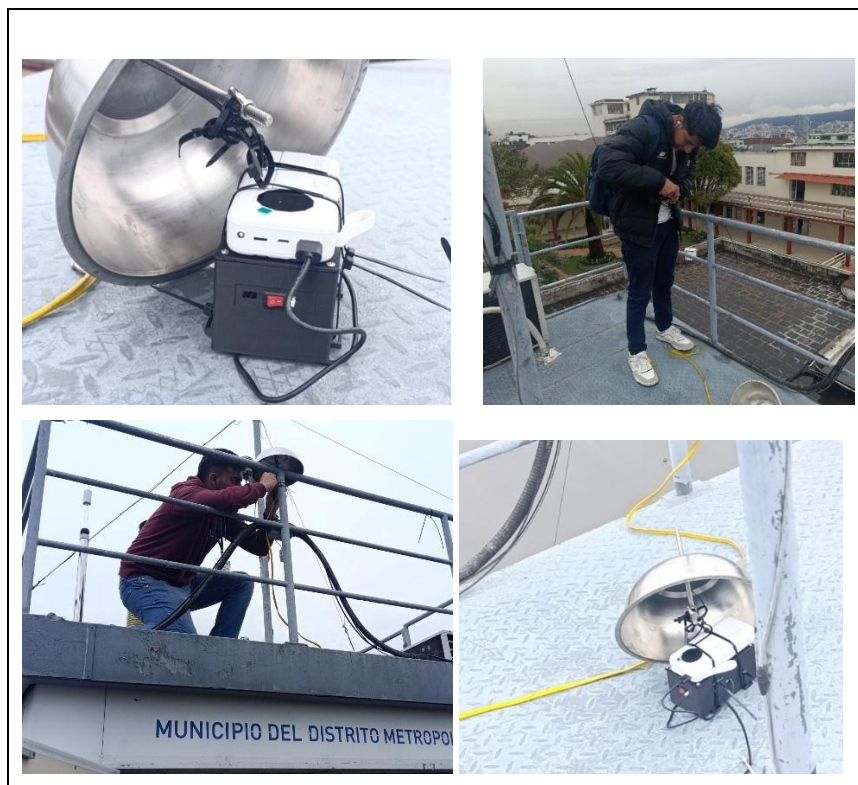
Figura 14. Sistema sensorizado en la estación de referencia Belisario durante el proceso de calibración.
