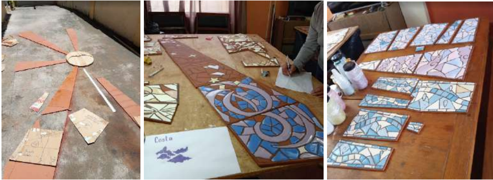
Figura 18 Proceso del policromado sobre cerámica
