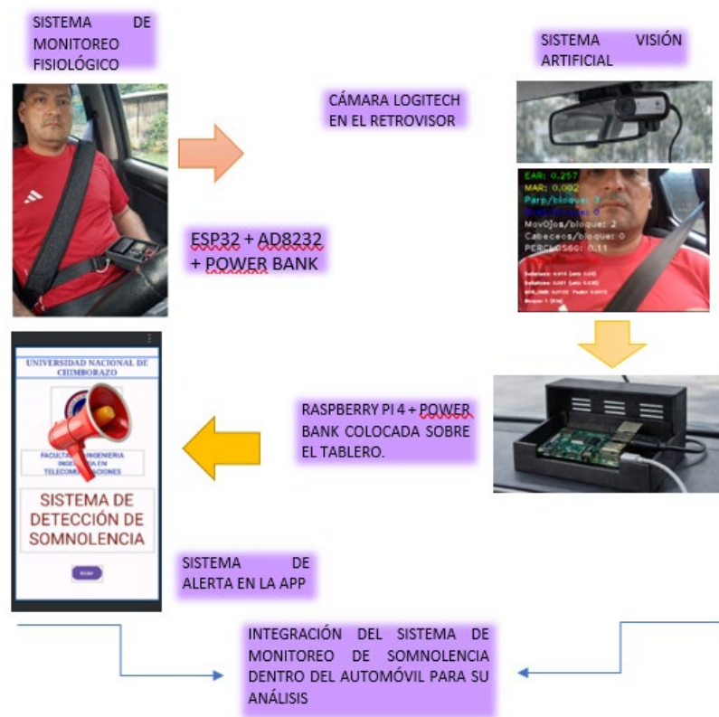
Figura 39: Integración del sistema de detección de somnolencia.
