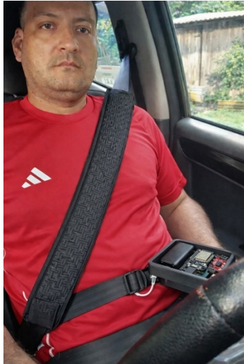
Figura 36: Almohadilla puesta sobre el cinturón de seguridad.
