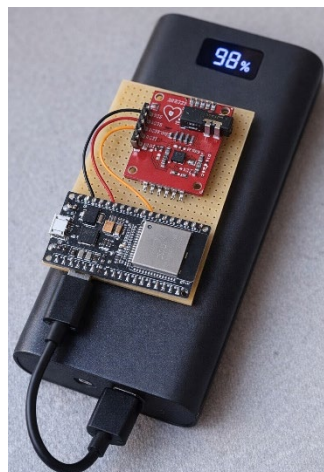
Figura 33: Circuito integrado del sistema de monitoreo ECG.
