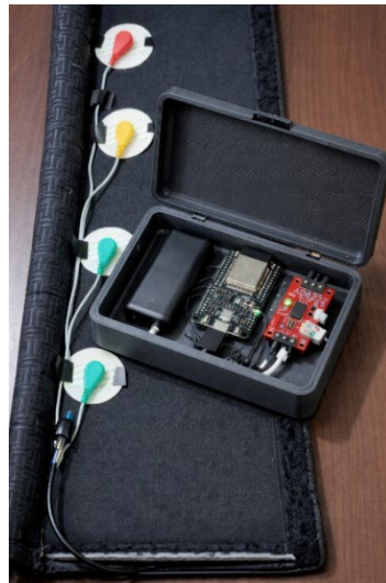
Figura 35: Almohadilla que se adhiere al cinturón de seguridad, con los electrodos dentro del mismo.
