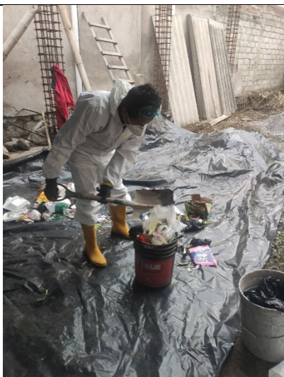
Fotografía 7: Técnica determinación de Densidades
