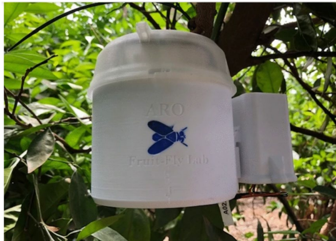
Figura 4. Imagen del prototipo de trampa electrónica McPhail colgado de un árbol de cítricos.
