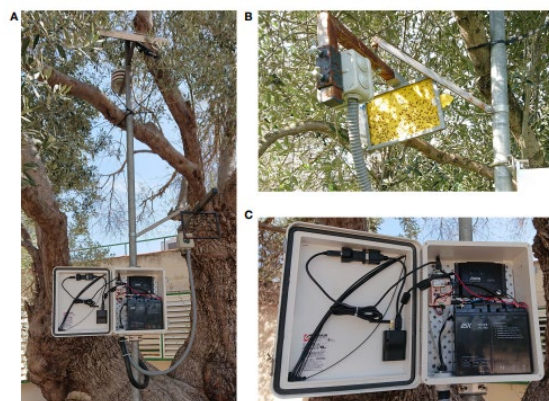
Figura 3. Componentes electrónicos de la trampa electrónica. (A) Trampa electrónica con panel solar, pantalla Stevenson para proteger el sensor de temperatura y humedad relativa. (B) Cámara colocada frente a una trampa Rimi®. (C) Batería y Electrónica.
