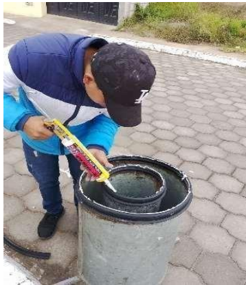
Figura 6. Colocación de Silicona en Anillos
