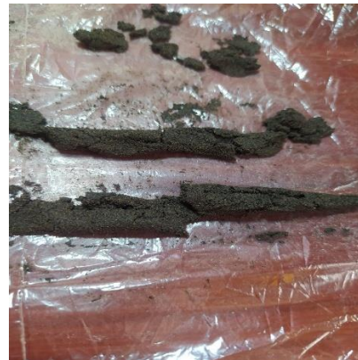
Anexo 5. Limite plástico para la subrasante (No posee).
