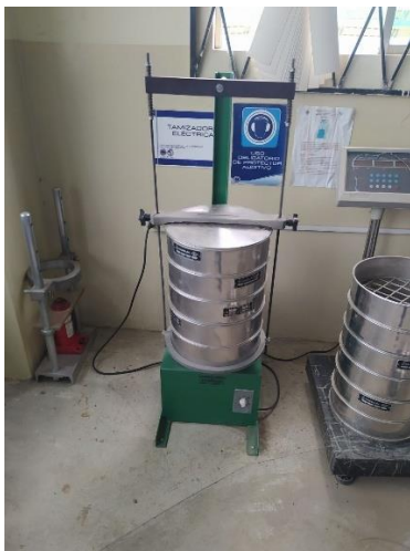
Anexo 3. Análisis granulométrico subrasante.
