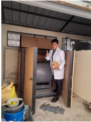
Anexo 8. Máquina de los ángeles, ensayo de abrasión.
