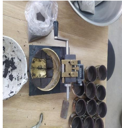
Anexo 4. Copa de casa grande, ensayo limite líquido.
