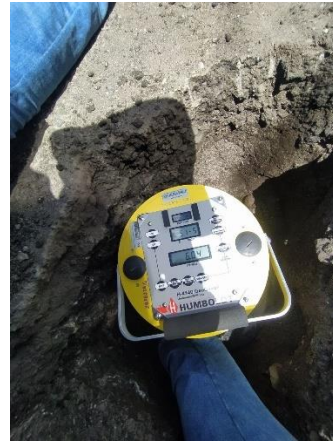
Anexo 16. Medición módulos-GeoGauge.
