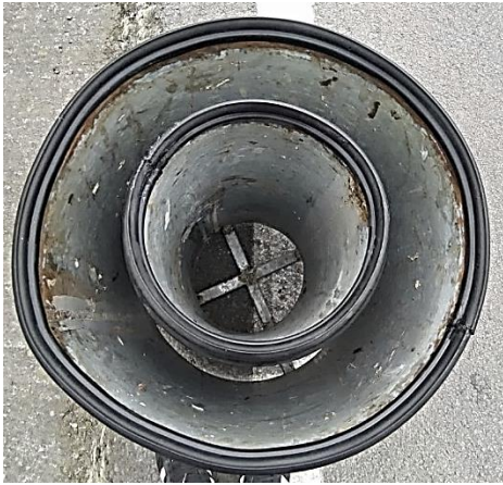
Figura 10. Colocación caucho en el infiltrómetro.
