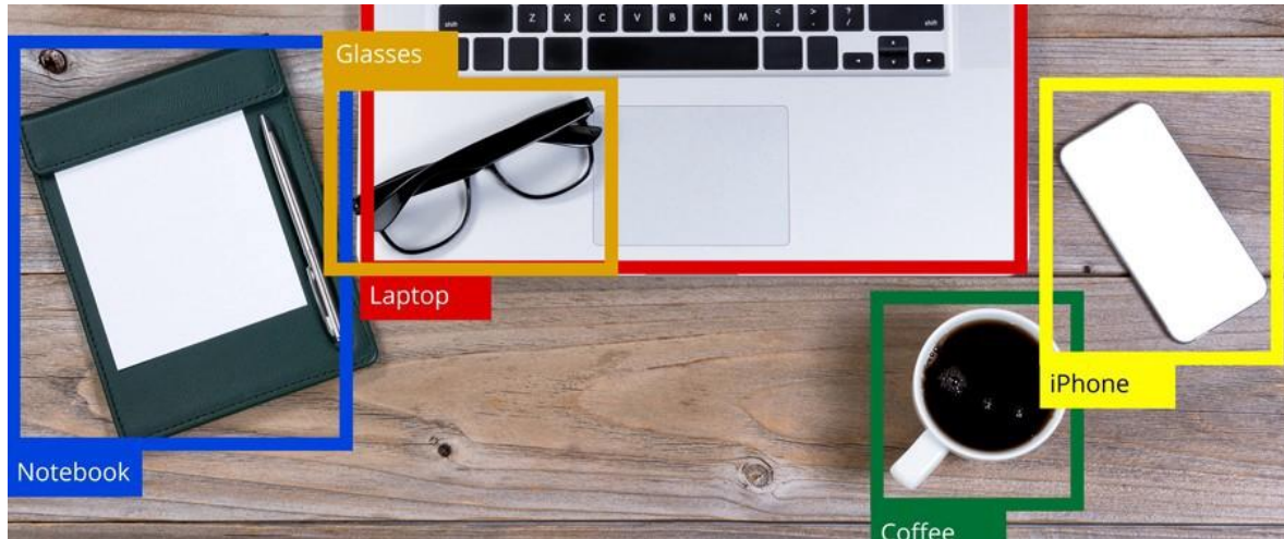
Figura 12 Detección de objetos mediante SSD MobileNet
