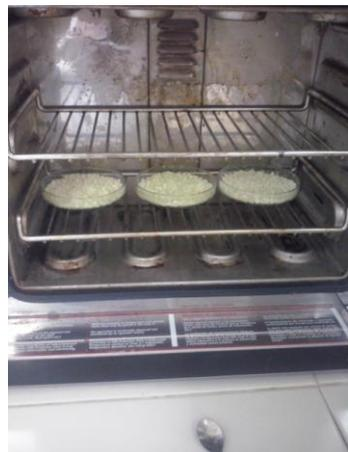
**Figura 17. Secado de la muestra**
