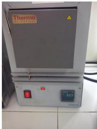
**Figura 27. Equipo para determinación de cenizas**
