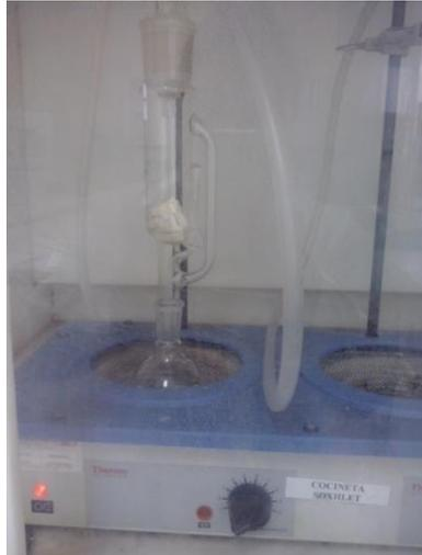
**Figura 28. Equipo para determinación de grasas**
