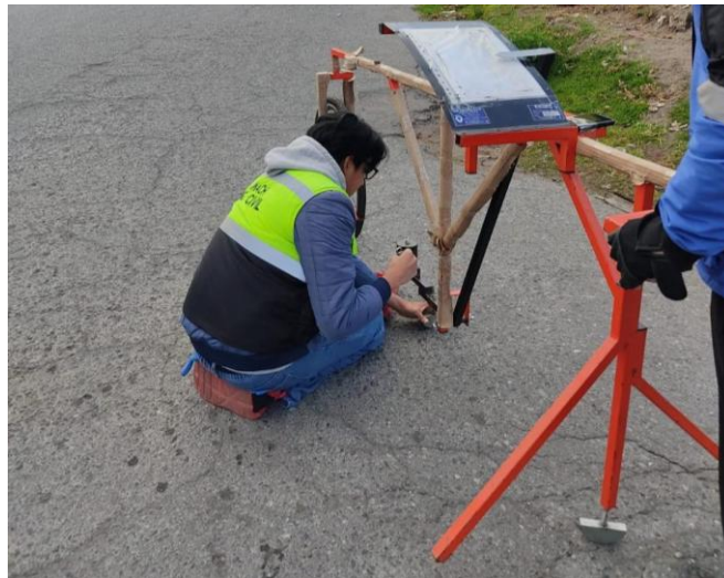
Figura 7. Calibración inicial del rugosímetro Merlin
