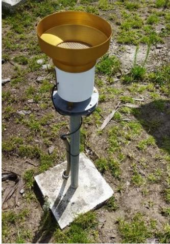
Figura 4: Pluviómetro
