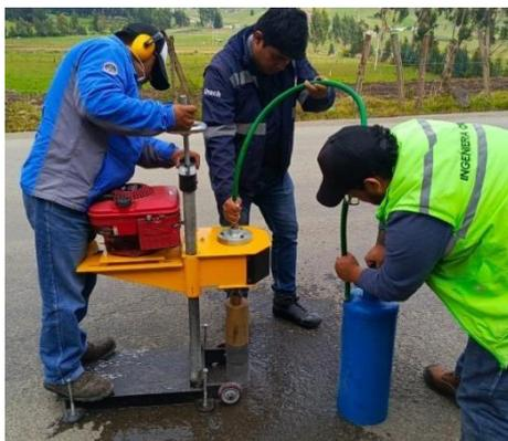
*Ilustración 5 Extracción de la muestra. Fuente propia.*
