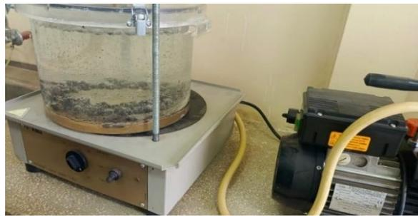
*Ilustración 4 Equipo para el ensayo de porcentaje de vacíos. Fuente propia.*
