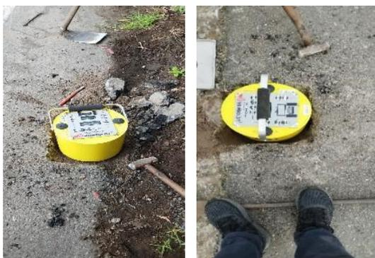
**Anexo 9:** Ensayo con el equipo GeoGauge.
