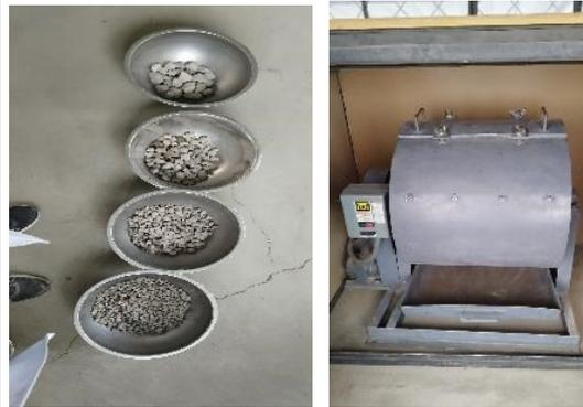
**Anexo 8:** Ensayo de abrasión, Máquina de los ángeles.
