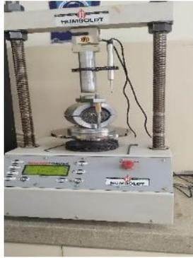
**Anexo 11:** Ensayo de estabilidad y Fluencia, Marshall.
