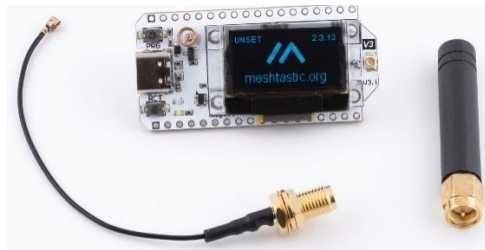
Figura 16. Microcontrolador ESP32 con módulo LoRa.
