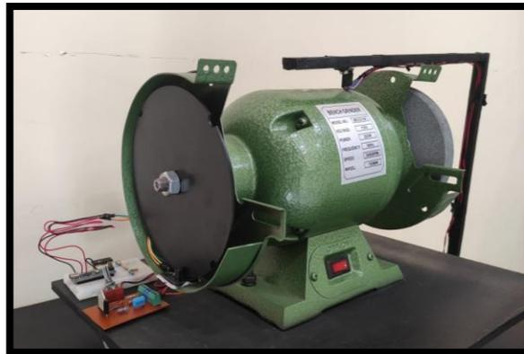
*Nota.* Banco de pruebas ensamblado con sensores. Fuente: Elaboración Propia
