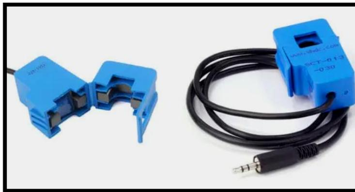
*Nota.* Sensor no invasivo SCT-013 utilizado para la medición de corriente alterna sin necesidad de cortar el conductor. Fuente: (Llamas, 2025)
