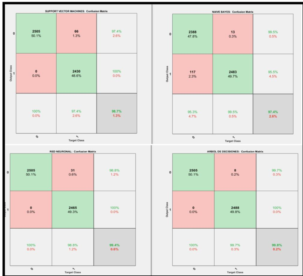
*Nota.* Representación de los aciertos y errores de clasificación de los modelos supervisados aplicados a la variable corriente. Fuente: Elaboración propia.
