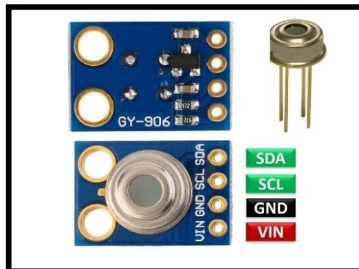
*Nota.* Sensor infrarrojo MLX90614 utilizado para la medición de temperatura sin contacto físico. Fuente: (Llamas, 2025)
