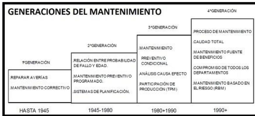
*Nota.* La figura muestra la evolución del mantenimiento a través de las generaciones industriales.
