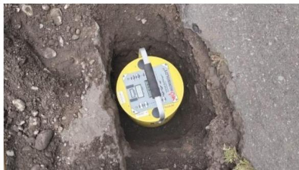
Para continuar con el ensayo in situ colocamos el aparato en la posición correcta el suelo tiene que estar nivelado y limpio, para poder hacer la pruebas encendemos el interruptor y
