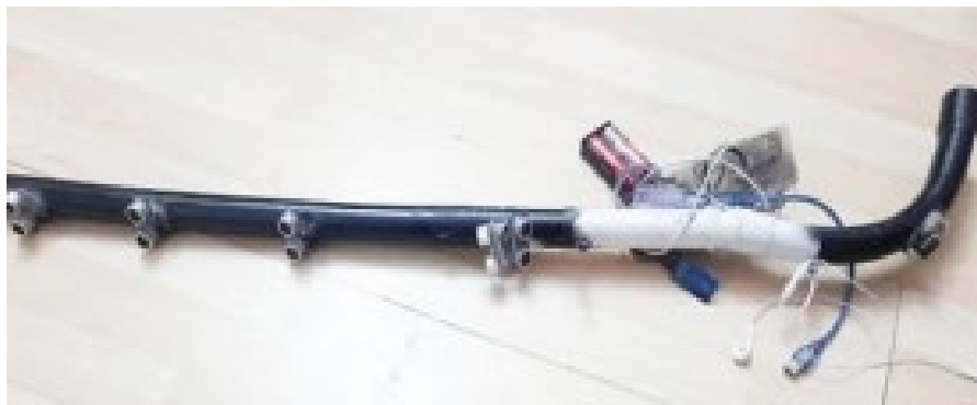
Figura 1: Bastón IoT con retroalimentación auditiva [5].
