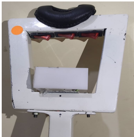
Figura 28: Mango del dispositivo con botones de selección de modo.
