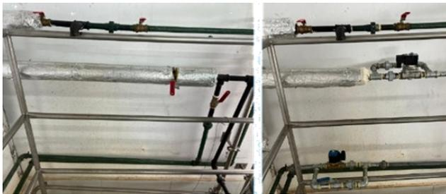
**Figura 26. Colocación del sensor en la yogurtera mediante un soporte**
