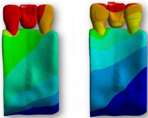
**Figura 3.** Desplazamiento de las prótesis sometidas a cargas: El desplazamiento total de las prótesis sometidas a cargas verticales y oblicuas se representa con un gradiente de color, donde los tonos más oscuros, especialmente el rojo, indican áreas con el mayor desplazamiento, evidenciando zonas de posible debilidad o inestabilidad estructural. (56)
