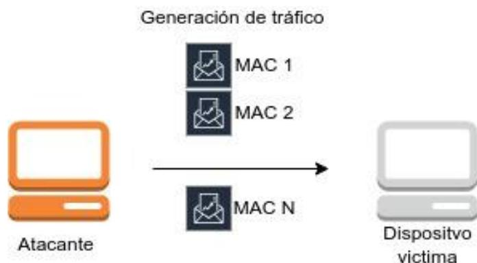
**Figura 6.** Funcionamiento del ataque SPOOFING MAC.
