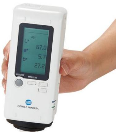
Son dispositivos triestimulares (tres filtros: rojo, verde y azul) para cada longitud de onda que se basan en la visión del ojo humano, emulando la respuesta del ojo al color y a la luz. Tienen diferentes iluminantes para la toma de mediciones y según la lámpara que proyecta la luz sobre el objeto, se percibe el color con desviaciones cromáticas que pueden ser importantes.
