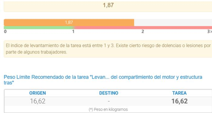
**Nota.** Según lo que se aprecia en la imagen, el índice de levantamiento del comportamiento del motor y estructura trasera es 1,87, es decir, está entre 1 y 3. Lo que significa que, se presenta un riesgo de malestares o lesiones que pueden ser afectados por parte de ciertos trabajadores de la carrocería Yaulema Jr. Fuente: Ergonautas.
