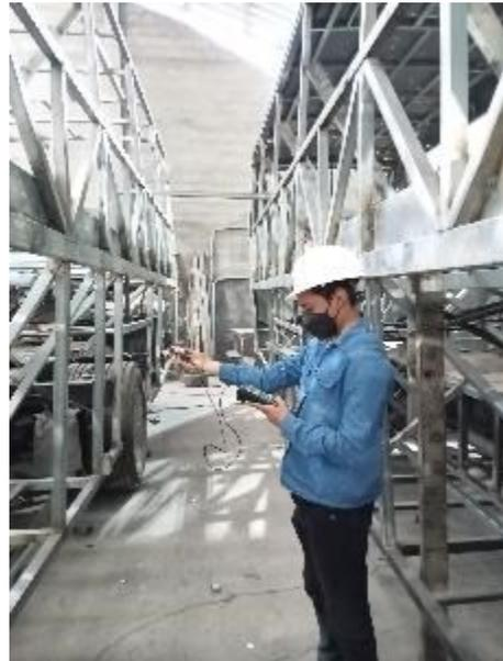
**Nota.** En las siguientes fotografías se muestran las mediciones de iluminación en el área de estructuración con ayuda del instrumento luxómetro. Elaborado por: Los autores.
