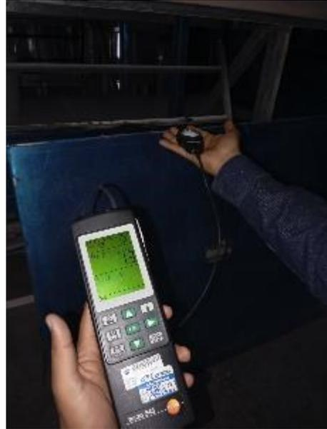
**Nota.** En las siguientes fotografías se muestran las mediciones de iluminación en el taller 2 con ayuda del instrumento luxómetro. Elaborado por: Los autores.
