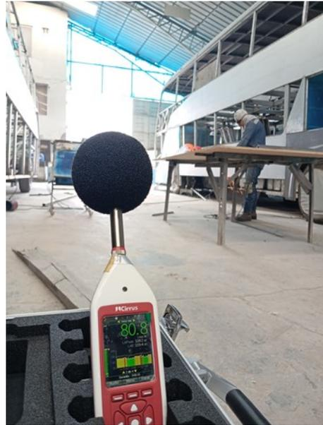
**Nota.** En las siguientes fotografías se muestran las mediciones de ruido en el área de laminado con ayuda del instrumento sonómetro. Elaborado por: Los autores.
