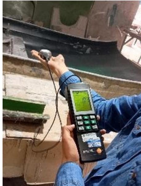
**Nota.** En las siguientes fotografías se muestran las mediciones de iluminación en el área de fibras con ayuda del instrumento luxómetro. Elaborado por: Los autores.
