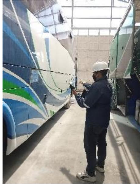
**Nota.** En las siguientes fotografías se muestran las mediciones de iluminación en el área de acabados con ayuda del instrumento luxómetro. Elaborado por: Los autores.
