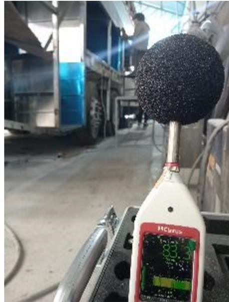
**Nota.** En las siguientes fotografías se muestran las mediciones de ruido en el área de estructurado con ayuda del instrumento sonómetro. Elaborado por: Los autores.
