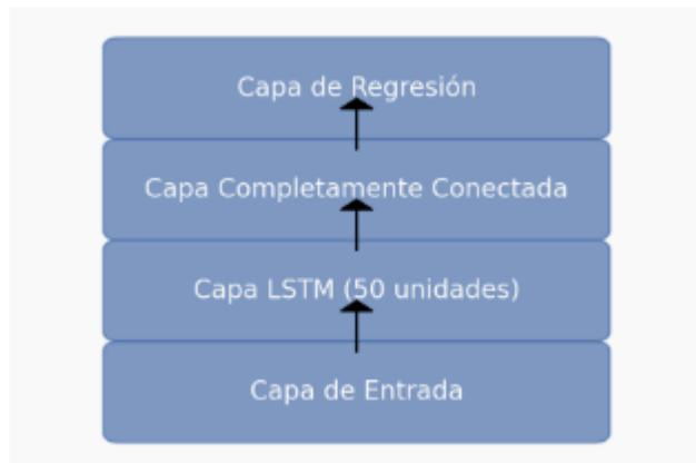
Figura 20.- Arquitectura del modelo LSTM
