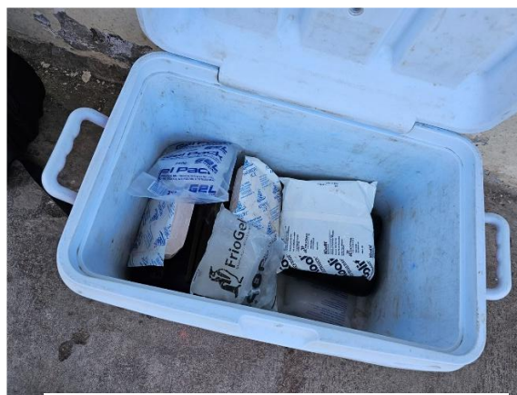
Fotografía 7. Transporte de la muestra de aguas residuales en hielera
