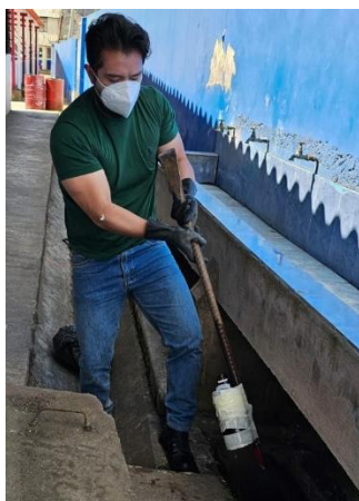
Fotografía 6. Toma de muestras de aguas residuales con frasco ámbar
