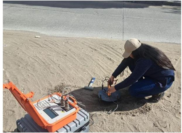
**Anexo 11.** Ensayo con densímetro eléctrico (EDG)
