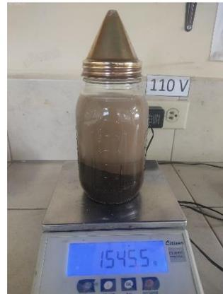
**Anexo 5.** Ensayo densidad de finos de la subbase
