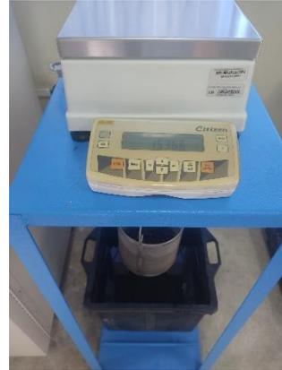
**Anexo 4.** Ensayo densidad de gruesos de la subbase
