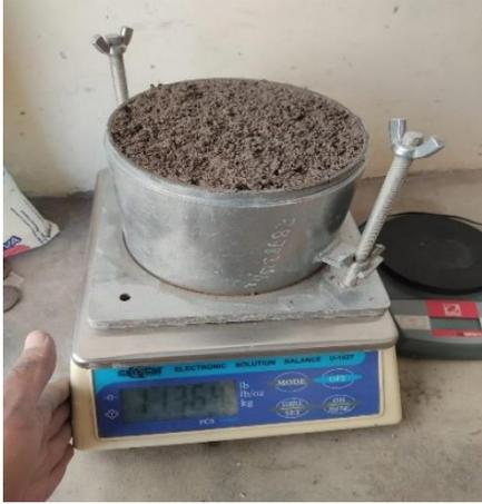
**Anexo 7.** Ensayo de Proctor Modificado Subbase tipo 2
