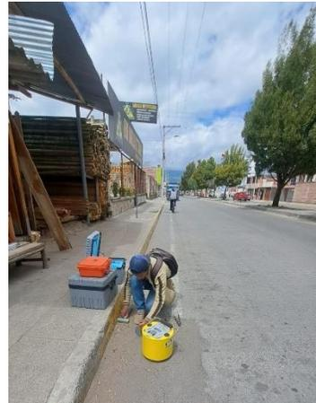
**Anexo 12.** Ensayo con el Geo Gauge
