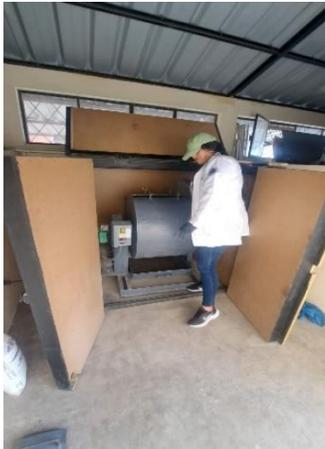
**Anexo 9.** Ensayo de abrasión en Máquina de los Ángeles
