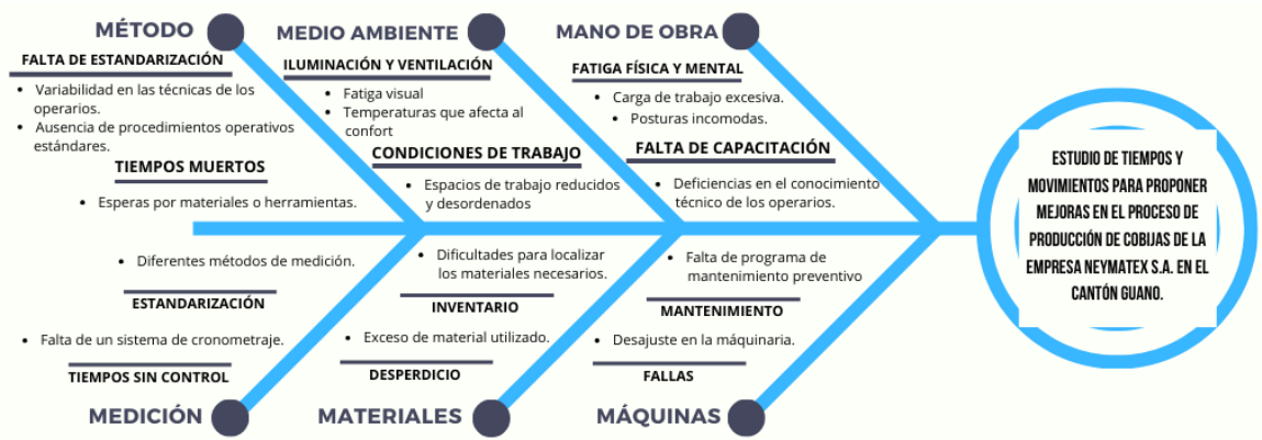
Ilustración 1 Diagrama de Ishikawa en base a la línea de producción de cobijas. (Elaborado por el autor)
